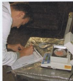
Fot. 1. Badanie zawilgoconia próbek muru przez Technika-laboranta
